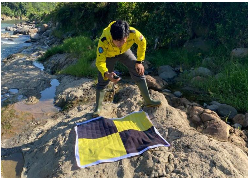
Gambar 2. Penggunaan Ground Control Point (GCP)
